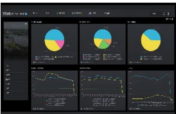
BEMS시스템은 건물의 에너지 사용을 모니터링, 제어 및 최적화 하기 위한 관리 시스템으로 건물 내의 전력, 가스, 물 등의 에너지 사용량을 실시간으로 모니터링하고, 데이터를 수집하여 분석합니다. 에너지 효율성을 개선하기 위한 다양한 기능을 제공하며 에너지 비용을 절감하고, 친환경적인 건물 운영을 지원합니다.
