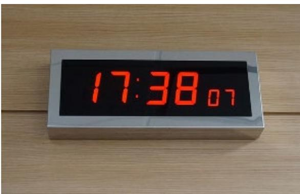
전기시계시스템은 건물이나 시설 내에서 정확하고 신뢰할 수 있는 시간정보를 유지하기 위한 시스템으로 GPS위성에서 신호를 받아 모시계로 데이터 저장 후 자시계로 데이터를 전송하며, 중간에 GPS가 끊기거나 전원 OFF 되어도 자체 전원장치를 통해 시간을 유지하고 시스템 복구시 자동으로 시간을 동기화합니다.
