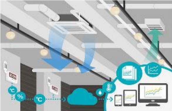
설비 자동제어시스템은 건물의 난방, 냉방, 환기 시스템을 제어하여 온도, 습도, 공기 품질 등을 최적화하고 이를 통해 건물환경의 쾌적성과 안정성을 도모합니다. 열원설비기기, 공조장비, 위생장비 등의 최적·고효율 운전으로 에너지 절감을 도모하며, 각종 설비의 운전 및 관리를 자동화하여 효율적인 관리를 지원합니다.
