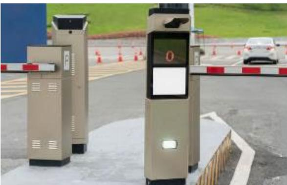
주차관제시스템은 건물이나 시설 내 차량 출입을 제어하고 관리하여 주차 공간을 효과적으로 활용하기 위한 시스템입니다. 필요에 따라 인증된 차량만을 출입할 수 있도록 하여 보안을 강화하고, 주차여부 실시간 모니터링, 주차 요금 징수 등을 통해 주차장 운영의 효율성, 안전성, 경제성을 증대 시킵니다.
